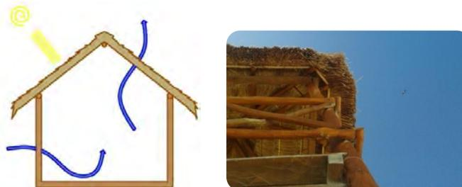
*Figura 15: Esquema de cubierta autoventilada*
